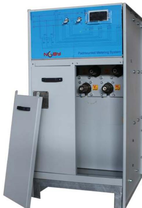
ترانسفورماتور اندازه گیری مرکب سه فاز روغنى(CIT) شامل سه ترانسفورماتور جريان تک فاز و دو ترانسفورماتور ولتاژ دو فاز است که برای اندازه گیری پارامترهای الکتریکی ولتاژ و جريان در شبکه توزیع فشار متوسط (12، 24 و 36 کیلوولت) مورد استفاده قرار میگيرد.
