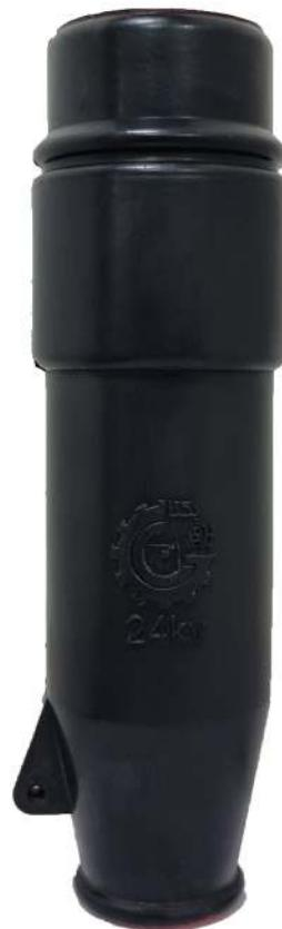
سرکابل مستقیم که از سیلیکون رابر ساخته شده، جهت اتصال کابل‌های فشار متوسط به RMU، موتورها، ترانسفورماتورها و دستگاههای اندازه گیری زمینی (CIT) و تمامی تجهیزاتی که دارای بوشینگ 250A می‌باشد، کاربرد دارد. این سرکابلها پس از نصب در راستای کابل و بوشینگ قرار می‌گیرد.
