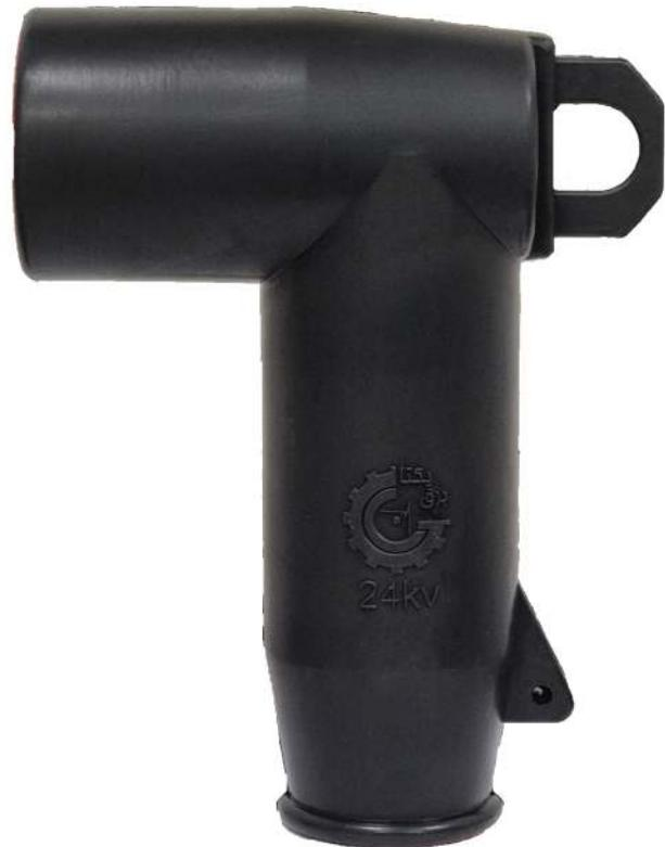
سرکابل زانویی جهت وصل کابل‌های فشار متوسط به بوشینگ 250A در ترانسفورماتورها، موتورها و تابلوهای متوسط فیوزدار (RMU) مورد استفاده قرار می‌گیرد.
